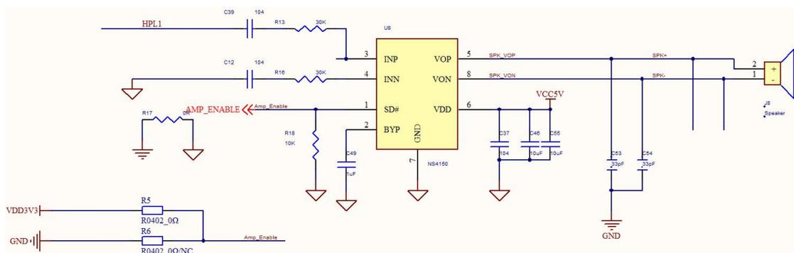
图 6-3 音频参考电路
