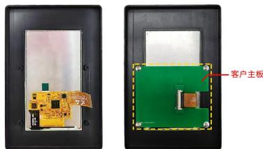
第四步：如上图所示，将客户主板安装于外壳上并拧紧螺丝固定，并插入排线
