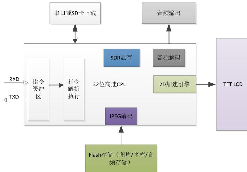
图 12-1 M 系列串口屏内部结构图
