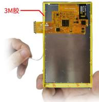
第二步: 如上图所示, 将触摸盖板后面四周3M胶保护膜撕掉, 露出3M胶
